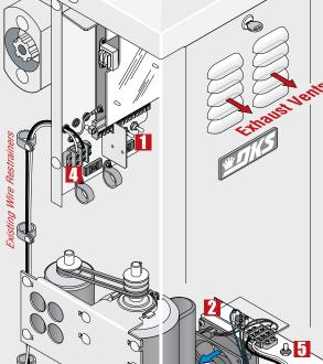
4 Connect the fan power wires.
