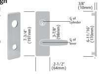
**Note:** The LS Escutcheon is not available with cylinder options: 10-63-, 11-60-, 11-63-, 11-64-, 60-, 63-, 64-, 70-, 72-, 73-, 65-73-, 65-73-P-, 73-PP-, 81-, 82-, 83-, 84-, F1-82-, F1-82- & F1-83-. Also not available with electrified functions: 70, 71, 72, 73
